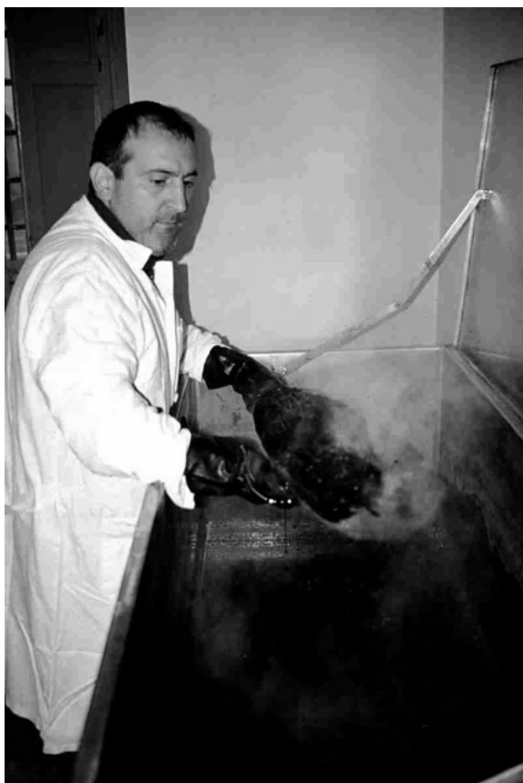
fig. 6 – Estrazione dei pali dalla vasca termoriscaldata.
