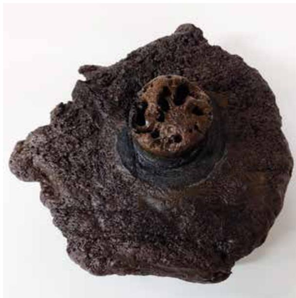
Fig. 4 - Mozzo della ruota superiore attaccato da *Teredo navalis*.
