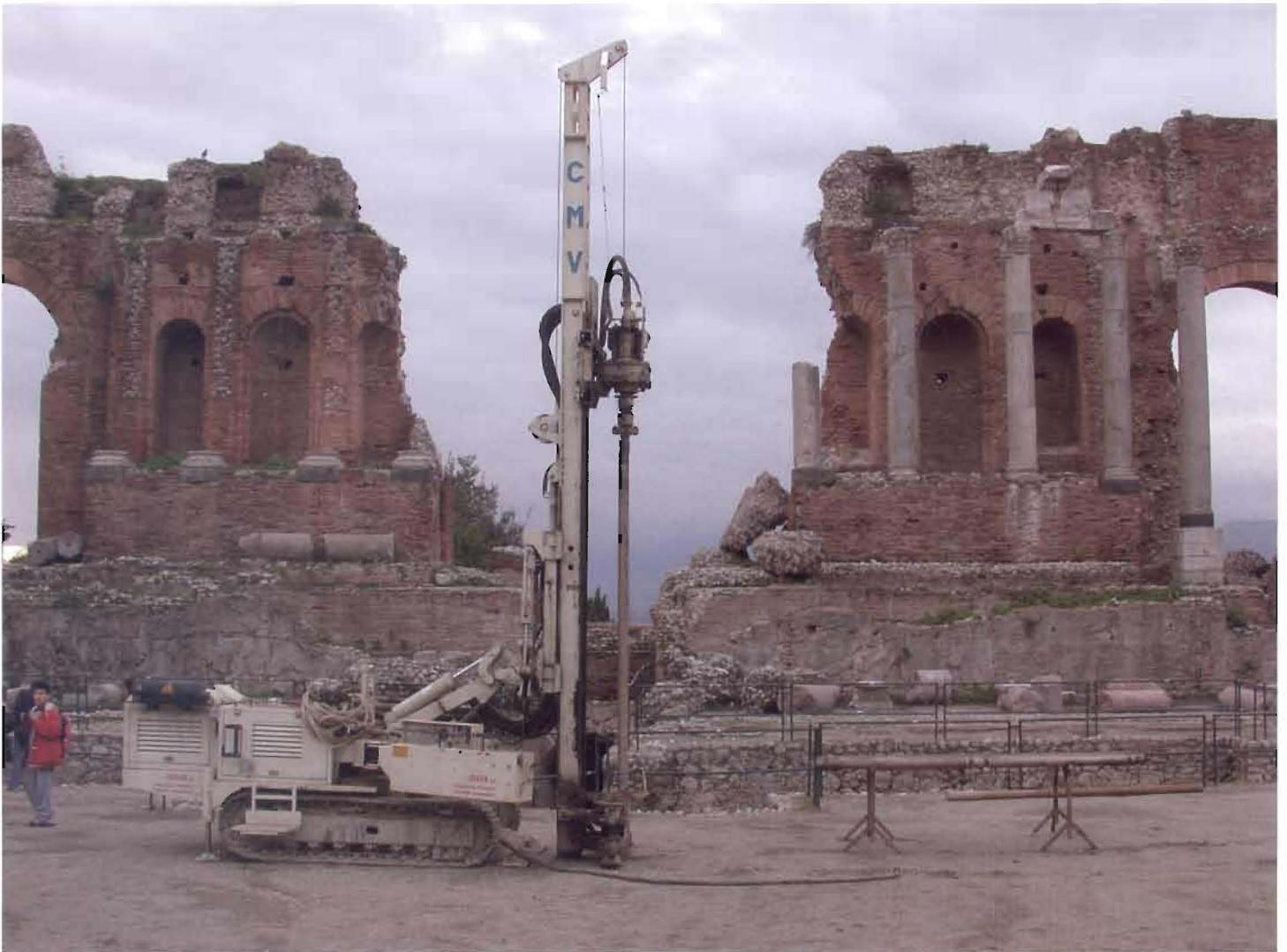
Fig. 3 - Sondaggio interno: carotatore
